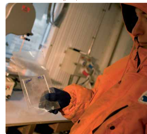
Lame mince de glace sur plaque de verre, au laboratoire Thin section of ice on a glass plate, in the lab
